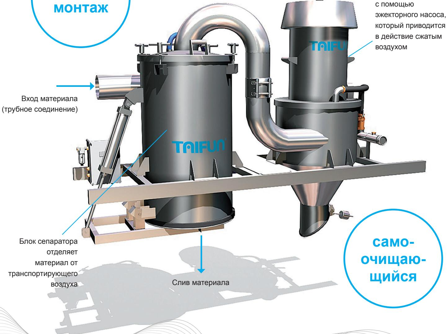
Система содержит только несколько изнашиваемых частей и построена с использованием модульных компонентов, которые можно заменить и починить на месте. Встроенная самоочищающаяся автоматическая система промывки способствует улучшению работы аппарата и повышает уровень гигиены, а также упрощает обслуживание.
