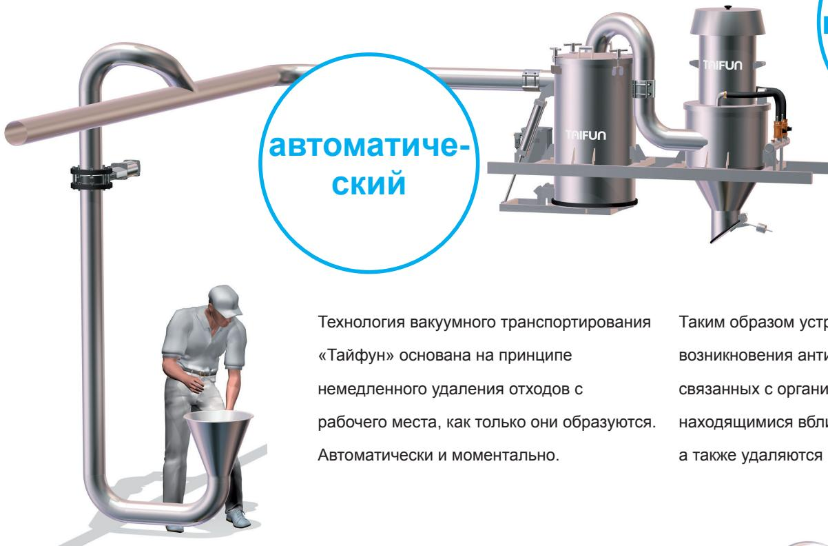
Технология вакуумного транспортирования «Тайфун» основана на принципе немедленного удаления отходов с рабочего места, как только они образуются. Автоматически и моментально.
